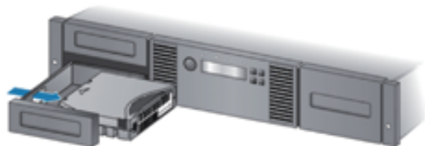
メディア格納部はマガジンを採用し、任意のメディア取り出しはメールスロットにより可能
